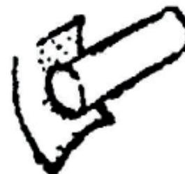
3. insérer le nouveau silencieux dans le tuyau avant du vtt, sans bague ni collet de retenue. Visser le support de fixation à la partie originale du Vtt
